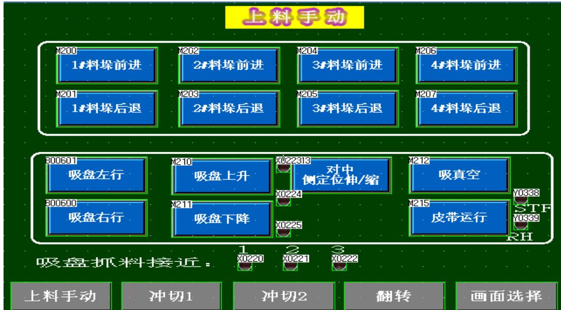
此界面为上料手动界面，包括 1-4 料垛的手动前进后退按钮，吸盘左/右，吸盘升/降，吸真空，皮带运行按钮，
