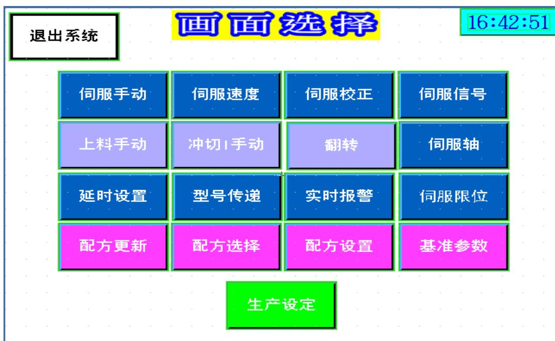
此界面为 1 触摸屏画面，包括：伺服手动，伺服速度，伺服校正，伺服信号，上料手动，冲切 1 手动，翻转，伺服轴，延时设置，型号传递，实时报警，伺服限位，配方更新，配方选择，配方设置，基准参数和生产设定。单击对应的按钮进入对应的画面中。
