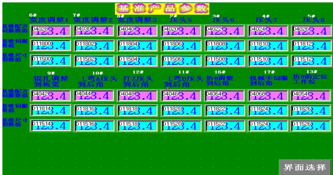
此界面为基准产品参数画面，输入基准产品尺寸图参数后，以便计算当前产品尺寸图使用。
