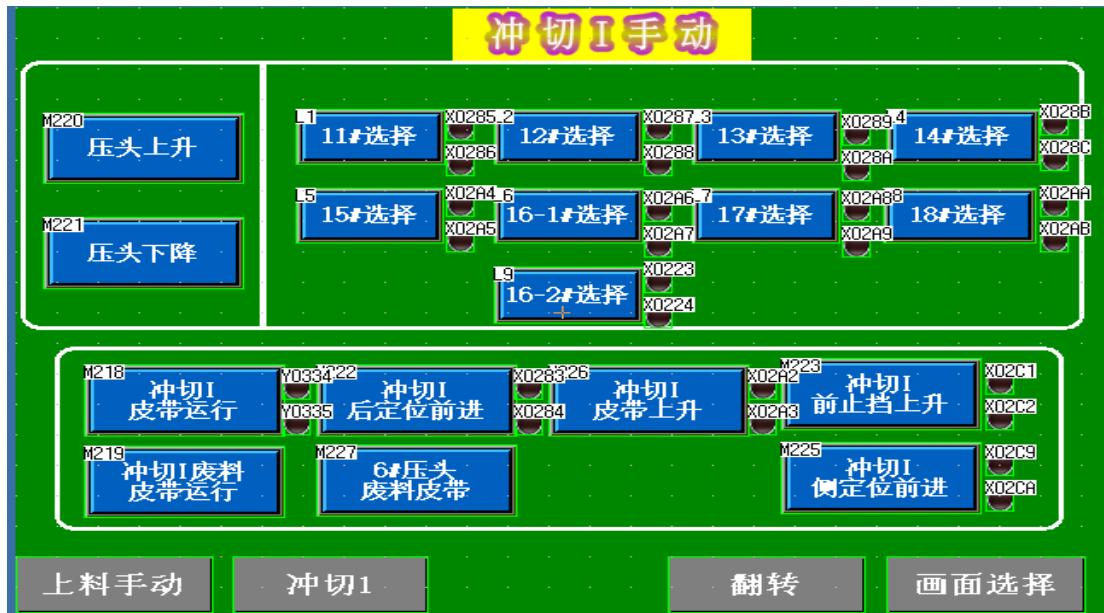
本界面给出了冲切 1 手动操作键界面：包括压头上升，下降，皮带电机运行，前止挡，侧定位，后定位气缸手动动作按钮。
