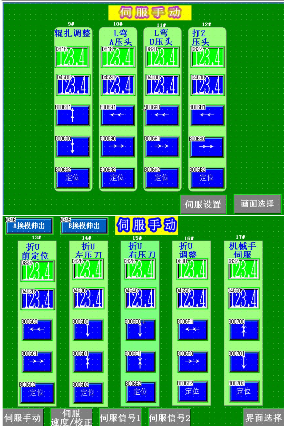
此界面上有设备各个伺服电机的操作键，点击相应的键即可对伺服进行相应的动作控制。
