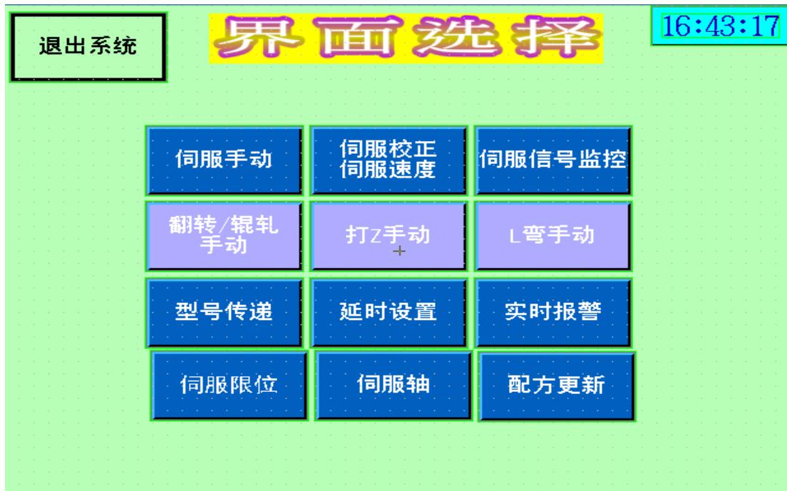
此画面为 2 触摸屏界面选择画面，包括：伺服手动，伺服校正，伺服速度，伺服信号监控，翻转/辊轧手动,打 Z 手动, L 弯手动，型号传递，延时设置，实时报警，伺服限位，伺服轴，配方更新。单击按钮进入对应的画面中。
