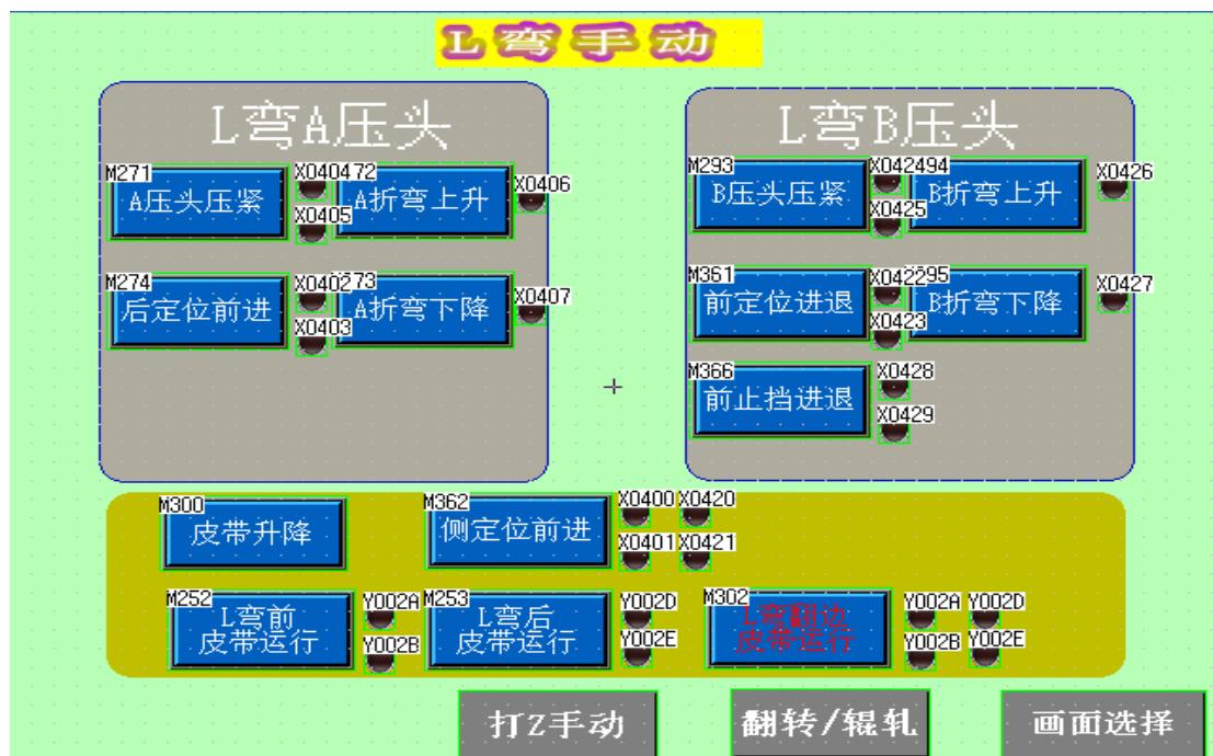
此界面为 L 弯手动界面，包括 L 弯压头升降，折弯升降，皮带升降，侧定位前进，L 弯前皮带运行，L 弯后皮带运行，L 弯翻边皮带运行。
