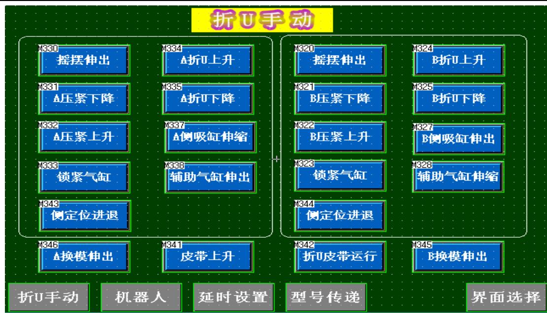
此界面为折 U 手动画面，包括：摇摆伸缩，折 U 升降，压紧升降，侧吸缸伸缩，锁紧缸，辅助气缸，侧定位进退，换模，皮带升降。换模缸伸出缩回。
