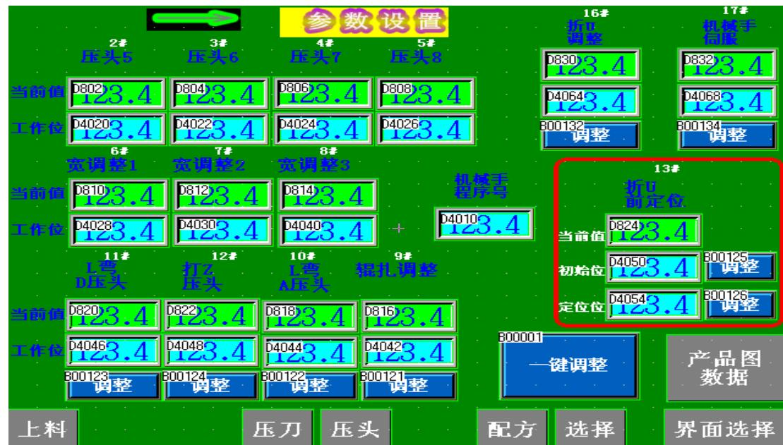
压头伺服，宽度调整伺服，辊轧伺服,L 弯打 Z 工位伺服，和折 U 工位伺服的伺服参数设置，
