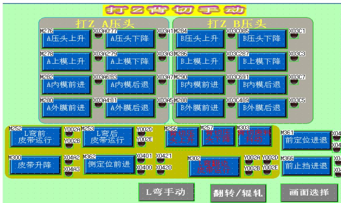
此界面为打 Z 背切手动界面，包括：打 Z 压头升降，上模升降，内模进退，外模进退，L 弯皮带运行，皮带升降，侧定位，前定位，前止挡手动状态下的动作。
